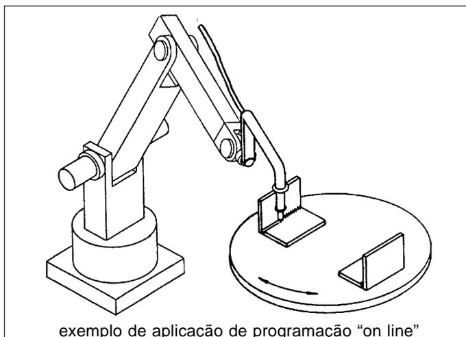
Durante a operação automática, simplesmente mandamos o robô repetir o que lhe foi ensinado e pronto. A desvantagem desse método de programação, no entanto, está na necessidade de interromper o trabalho normal de produção do robô para ensinar-lhe uma nova tarefa.
