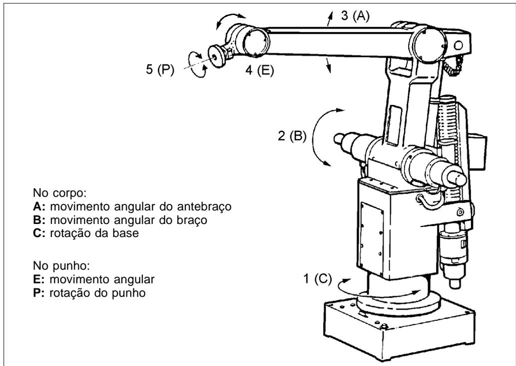
Portanto, este é um robô de cinco graus de liberdade: três graus de liberdade no corpo e dois graus de liberdade no punho. Os graus de liberdade do corpo do robô definem a posição do centro da flange do punho. Assim, quando movemos os eixos A, B e C do robô, cada qual num determinado ângulo, a posição do centro da flange fica perfeitamente definida.
