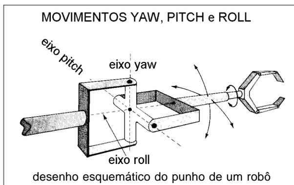
Para executar seu trabalho, o robô necessita de uma ferramenta que pode ser simples, como uma pistola de solda a ponto ou uma lixadeira. Ou de uma ferramenta complicada, como as utilizadas para manusear pára-brisas de automóveis. Essa ferramenta, denominada órgão terminal, é fixada na flange do punho do robô.
