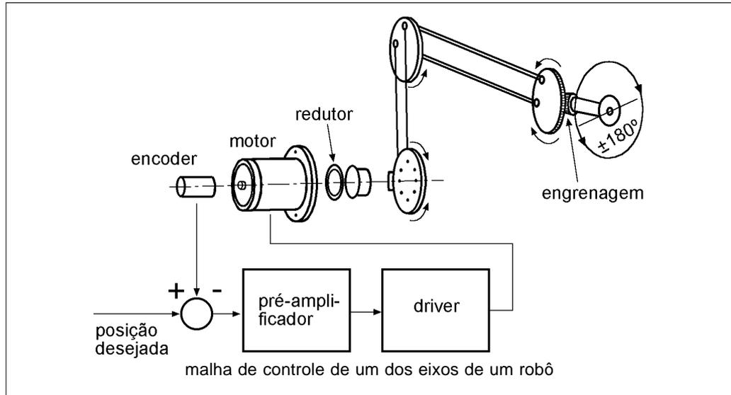
Controlar os movimentos de um robô consiste, basicamente, em fazer com que seus motores girem, associados a cada uma das juntas da estrutura do robô, de modo que o órgão terminal atinja posição e orientação desejadas.
