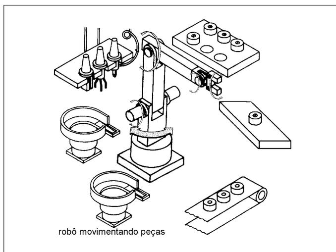
Os robôs também podem manusear peças para a montagem de um determinado produto. É o que ocorre quando se ajusta um pára-brisa na carroceria de um automóvel.
