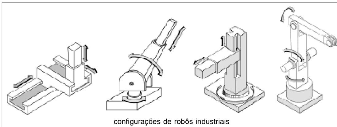
A grande maioria dos robôs é acionada por meio de servomotores elétricos. O acionamento elétrico, ao contrário do pneumático ou hidráulico, é mais facilmente controlável e oferece maior precisão de posicionamento.
